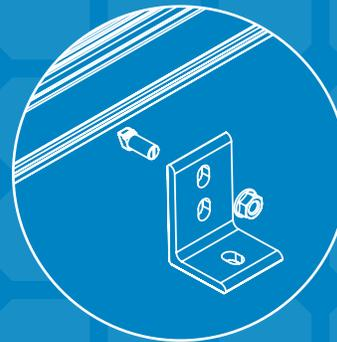
UNIÓN INTEGRADA CON L-FOOT Y T-BOLT
